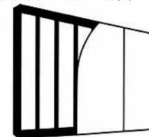
必ず天地方向を1枚のボードで仕上げ、横継ぎを作らないようにします。また、この場合は生木によるソリ、ネジレに特に注意して下さい。
