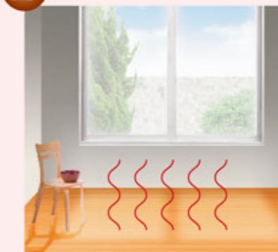
1時間程度、試運転を行って敷設範囲の床表面温度の上昇を必ず確認して下さい。
